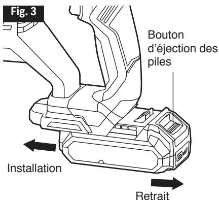
**REMARQUE :** Lorsque vous placez le bloc-piles sur l'outil, assurez-vous que la nervure en relief sur le bloc-piles est alignée sur la rainure de l'outil et que les verrous se referment correctement. Une installation incorrecte du bloc-pile pourrait endommager les composants internes.
