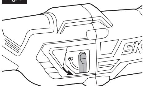
Utilisez le sélecteur d'action orbitale pour sélectionner soit une action de coupe linéaire, soit une action de coupe orbitale. Une action de coupe linéaire est appropriée pour réaliser des coupes lisses, tandis qu'une action de coupe orbitale est préférable pour réaliser des coupes rapides.
