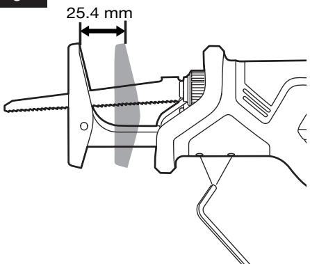
**ADVERTENCIA** Para evitar sufrir lesiones y daños, no utilice la sierra si la base de apoyo giratoria no se encuentra en su lugar. La abrazadera de la hoja se puede golpear contra la pieza de trabajo y dañar el mecanismo de vaivén.
