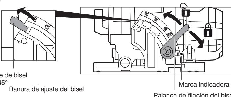
**NOTA:** Cuando corte en bisel, la profundidad de corte no corresponderá con el valor de la escala de profundidad.
