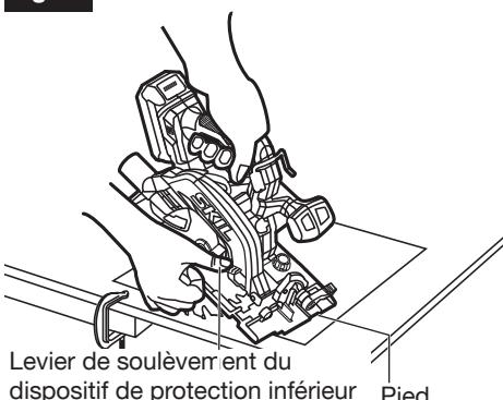
h. Une fois que le pied de la scie repose à plat sur la surface à couper, poursuivez la coupe vers l'avant jusqu'à la fin de la coupe.
