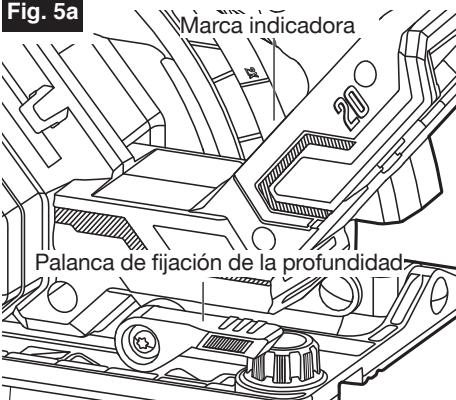
d. Apriete firmemente la palanca de fijación de la profundidad a la profundidad deseada.
