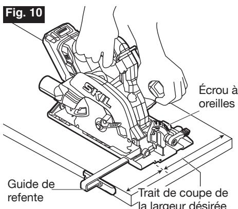
Étant donné que les épaisseurs des lames varient, vous devez toujours effectuer une coupe d'essai dans des matériaux de rebut le long d'une ligne directrice afin de déterminer de combien la ligne directrice doit être décalée par rapport au guide pour produire une coupe précise.
