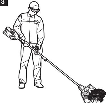
Cuando utilice el aditamento de pala quitanieves, sujetela herramienta con un agarre firme con las dos manos mientras esté en funcionamiento (Fig. 3).
